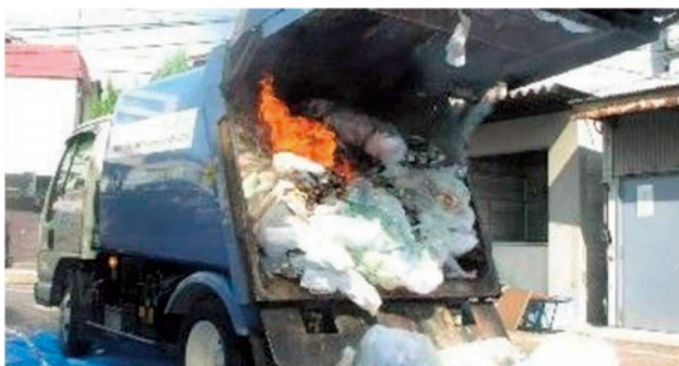
タンク内から発生した火がごみに引火している様子 (写真：東京清掃労働組合)
